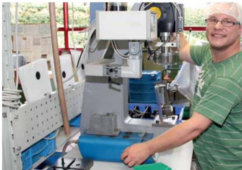
Franz Matz beim Verstemmen von Kugeln in Gehäusen für die Firma Schaeffler.
