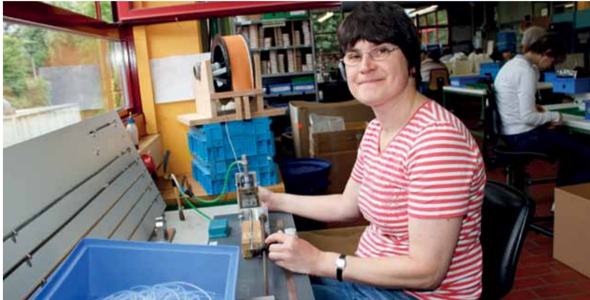
Silke Meier an der Schlauchschneidevorrichtung für die Firma Agilent, wo sämtliche Schläuche auf Länge geschnitten werden.
