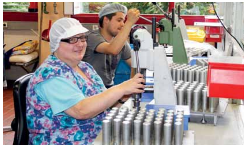
Dichtringmontage von Nehmerkolben für Schaeffler-Marke LuK
