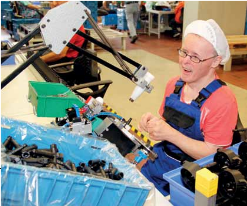
Verschiedene Bauteile für Schaeffler in Bühl werden in den Werkstätten der Lebenshilfe montiert, kontrolliert und verpackt; hier Montage von Kupplungsnehmern.
